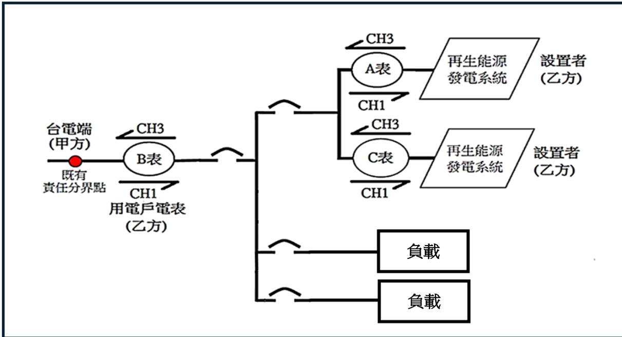
(一) 乙方發電電能自行使用度數  $= (\text{MOF}_{A, (C, \dots)} \text{CH3} - \text{MOF}_B \text{CH3})$  之度數。
